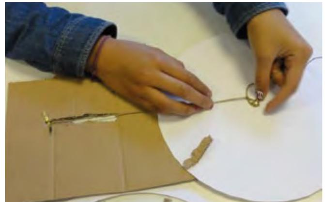
*Ce groupe a relié le piston et la roue à l'aide d'un dispositif souple (ficelle). La rotation peut avoir lieu quand on écarte le piston, mais pas quand on le rapproche.*
